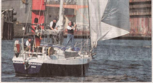
Skipper Jens Quade (53) hat seine Yacht selbst ausgebaut. Der Doppelkieler ist mit 12,3 Meter Länge über alles und nur 1.5 Meter Tiefgang sehr stabil und optimal zum Ansteuern flacher Buchten geeignet.
